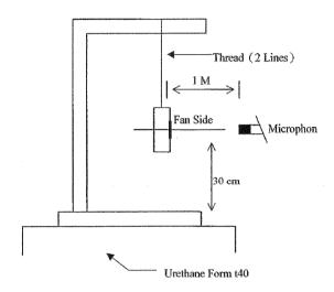
1 METER FROM MICROPHONE TO FAN INTAKE
